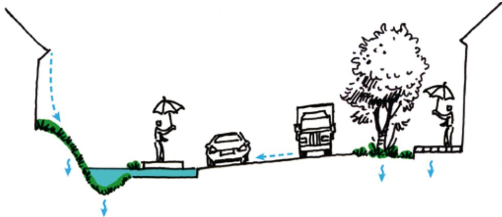
*Écoulement des eaux résultant d'une pluie courante dans le système mineur : canalisation, noue, surfaces perméables. La vie et les fonctions de la ville ne sont pas perturbées.*
